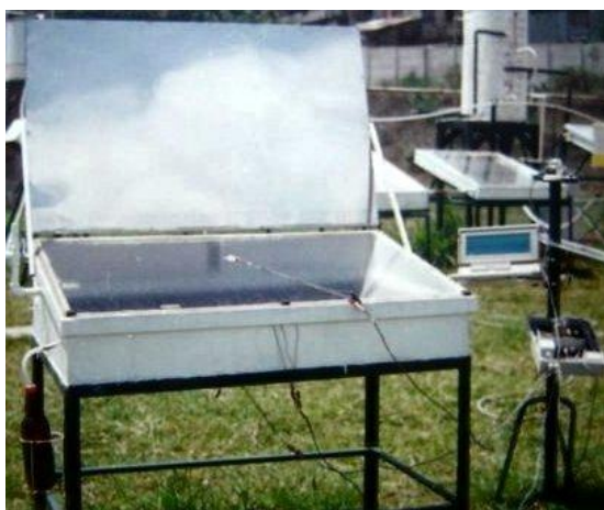
Fig. 7: Varios Destiladores solares diseñados e estudiados por el autor durante 1984-1989. Foto V (ultima) muestra el modelo explicado detalladamente en el presente folleto (Sin reflector).
